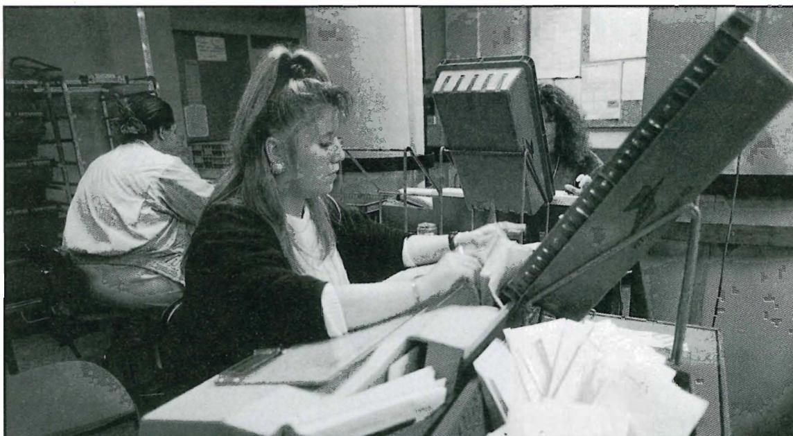
● Des postes d'indexation impriment les codes barres, traduction mécanique du code postal chiffré, qui seront ensuite lus dans les centres de tri automatiques.
